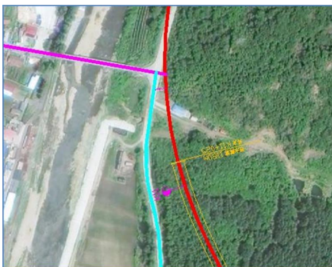
图 13 G506 旧路隧道出口接线方案图
