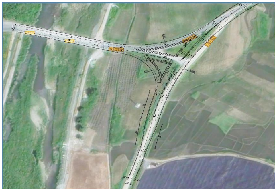
图 14 路线终点渠化 T 型交叉方案图
